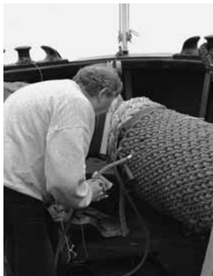
Seppo Järveläinen viimeistelee köydestä tehtyä Turson törmäyssuojaa, joka myös saatiin paikoilleen, kuten ylempi kuva kertoo. (Pekka Snellman)
