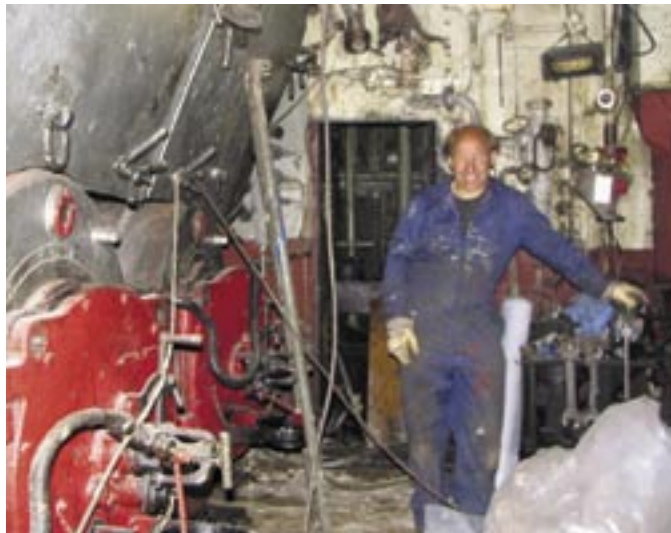
Turson konehuoneen putkiviidakon kunnostaminen ja öljyputkistojen poisto on ollut valtava operaatio. Turson kaksi kattilaa on asennettu vastakkain. Kuvat. Raimo Wirrankoski.
